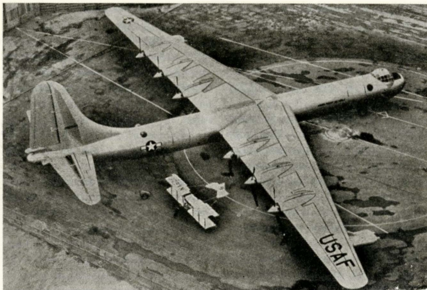
B 36-flyvemaskinen med seks stempelmotorer, der driver propeller, og fire reaktionsaggregater.
